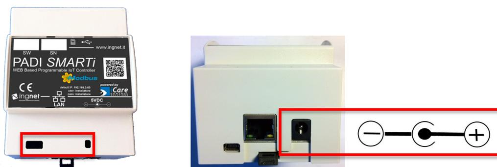
La centralina si accenderà automaticamente non appena si collega il cavo di alimentazione; il LED blu in basso a destra rimarrà acceso indicando che la centralina è accesa; i LED blu in basso a sinistra inizieranno invece a lampeggiare indicando all'utente il caricamento del software interno di gestione (l'operazione richiede circa 40 secondi).
